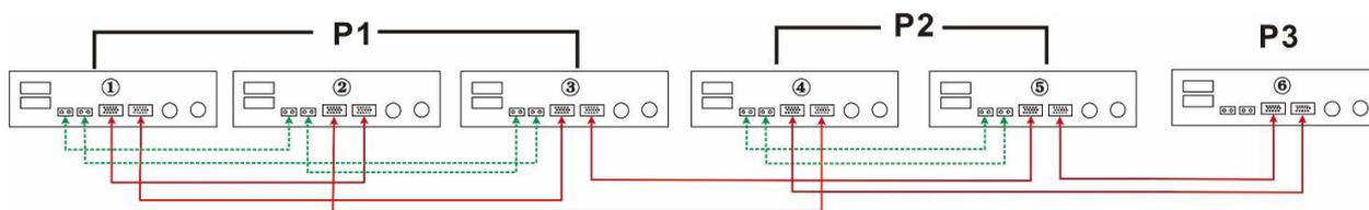
Примечание: если к фазе подключен один ИБП, то к нему не нужно подключать общий токовый кабель.
