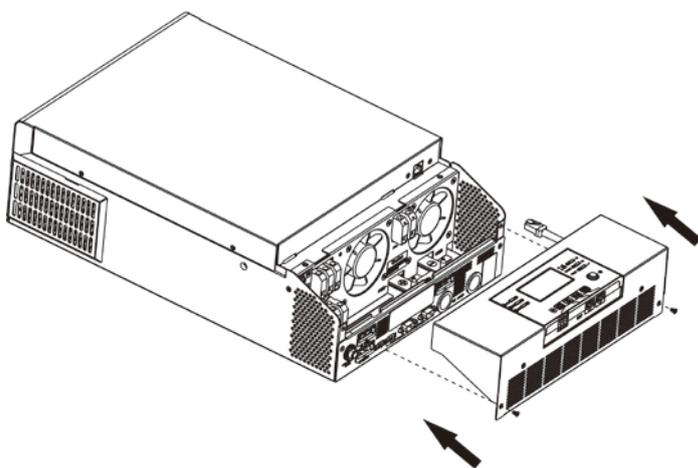
**Шаг 7:** Установите крышку отсека для проводов обратно в устройство. Теперь ИБП поддерживает функцию параллельной работы.
