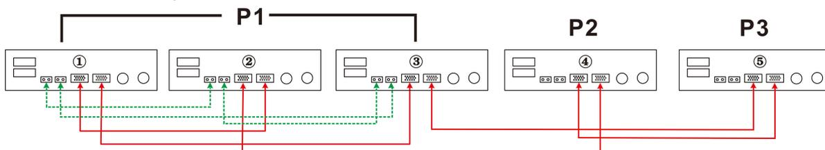
Два ИБП в первой и второй фазе и один ИБП в третьей:
