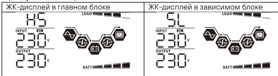
Шаг 5: Если сигналы о неисправности больше не появляются, параллельная система полностью установлена.
