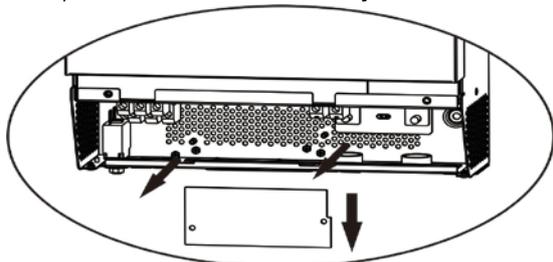
**Шаг 3:** Открутите два винта, чтобы снять заглушку для установки платы для параллельного подключения.
