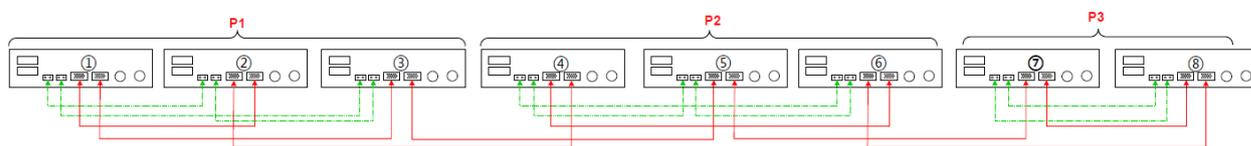
Семь ИБП в одной фазе и по одному ИБП для двух других фаз:
