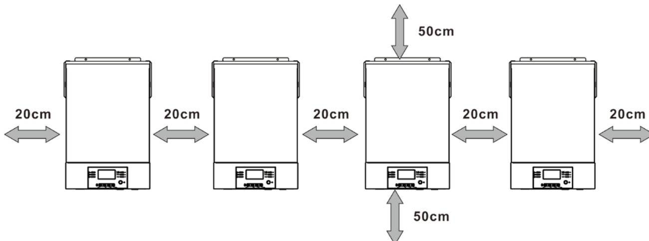
**ПРИМЕЧАНИЕ.** Для правильной циркуляции воздуха для отвода тепла необходимо обеспечить свободное пространство прилб. 20 см сбоку и прилб. 50 см над устройством. Каждый блок должен быть установлен на одном уровне.
