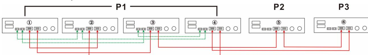
Три ИБП в первой фазе, два ИБП во второй фазе и один ИБП в третьей фазе:
