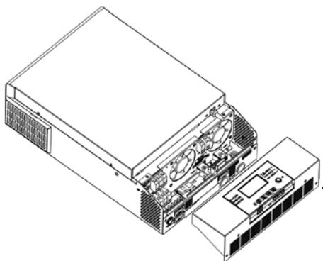
**Шаг 2:** Открутите два винта, затем снимите 2-контактный и 14-контактный кабели. Выньте плату, которая находится под коммуникационной платой.
