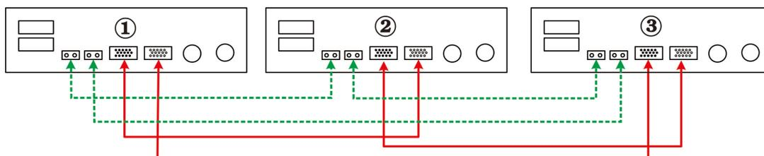
Четыре ИБП параллельно:
