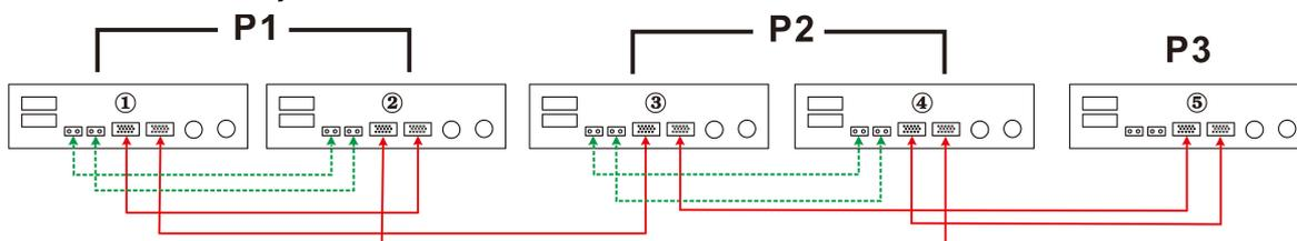
Два ИБП в одной фазе и по одному ИБП для двух других фаз:
