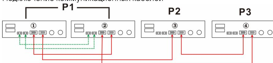
По одному ИБП в каждой фазе:
