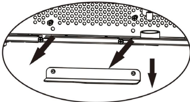
**Шаг 4:** Установите плату для параллельного подключения и закрутите 2 винта.
